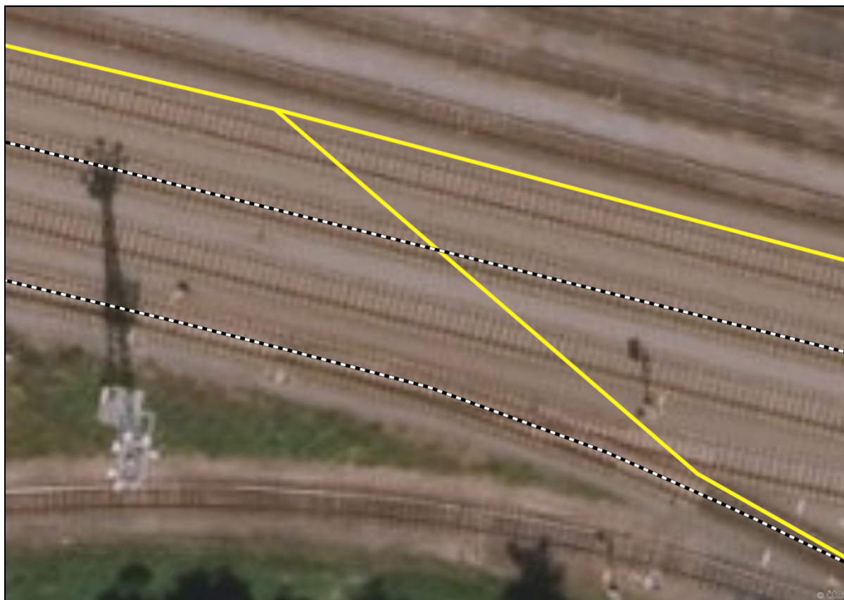
Obr. 6 – Oprava původ. (žlutého) ved. žel.í tratě do správné osy koleje (Mapový podklad: ČÚZK, ZÚ Ostrava)
